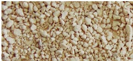
**POLVO DE PIEDRA 1/8****Granulometría:** De 1/8" a 0"**Peso volumétrico\* aprox.:** 1,350 kg/m<sup>3</sup>**Uso:** Para cualquier tipo de mezclas de concreto y acabados
