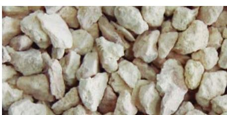
**GRAVILLA DE 3/8"****Granulometría:** De 3/8" a 1/8"**Peso volumétrico\* aprox.:** 1,200 kg/m<sup>3</sup>**Uso:** Para sellos asfálticos, concreto asfáltico, hidráulicos y vibroprensados
