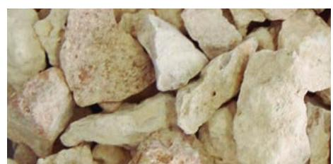
**GRAVA DE 1"****Granulometría:** De 1" a 3/8"**Peso volumétrico\* aprox.:** 1,150 kg/m<sup>3</sup>**Uso:** Para todo tipo de concreto
