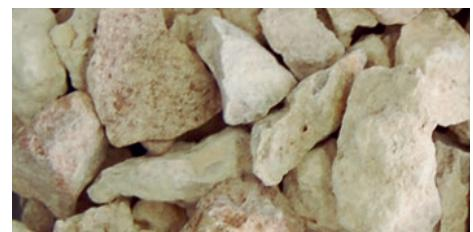
**GRAVA DE 1"****Granulometría:** De 1" a 3/8"**Peso volumétrico\* aprox.:** 1,150 kg/m<sup>3</sup>**Uso:** Para todo tipo de concreto**\*Sobre pedido**
